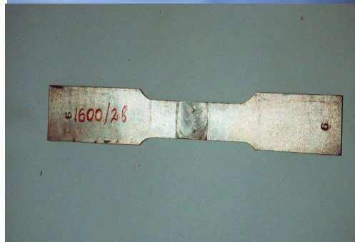
Fig 3: (c) at 1600rpm/26mm/min. (d) at 1600rpm/28mm/min.
